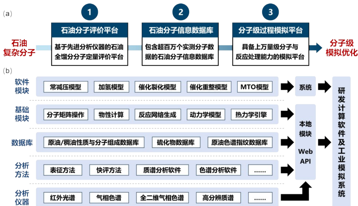
图1 石油分子工程数据库及过程模拟平台的核心功能及整体架构。(a)核心功能;(b)整体架构
